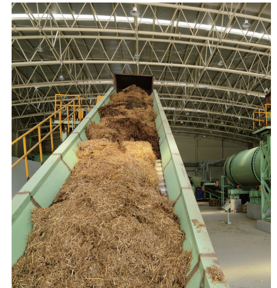
輸送帶上的秸稈準備進入 nPulp 製程
